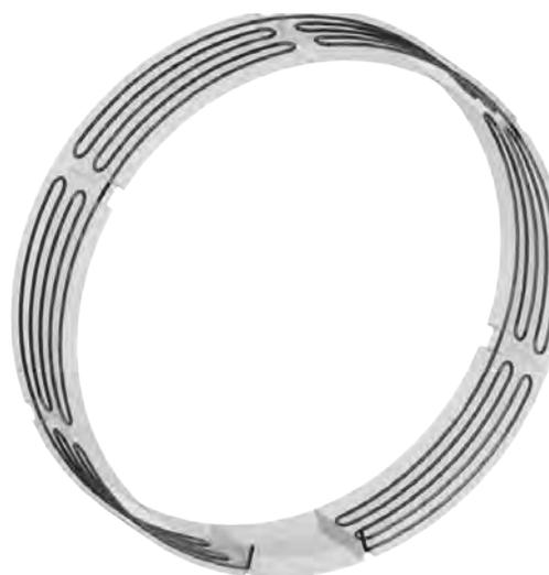
Sopra, un anello con sonde geotermiche disposte in modo tradizionale; sotto, lo stesso anello con sonde disposte in direzione trasversale rispetto all'asse principale della galleria, come previsto dal progetto EnerTun (Barla, Di Donna - Polo di Innovazione Regionale Enermyh).
